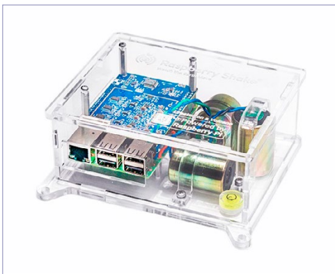
↑ Erdbebenmessgerät Raspberry-Shake. Quelle: https://shop.raspberrypi.org
